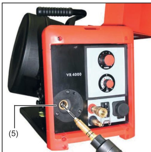
Infilare la torcia per saldatura nell'attacco per Tweco.
